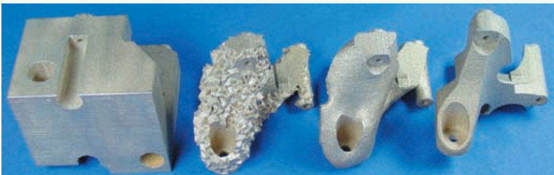
Abbildung 8: Prototypen des Motorträgers hergestellt nach 3D-Printing Verfahren (a. Bauraum, b. optimiertes Modell, c. geglättetes Modell, d. Nachkonstruktion)
