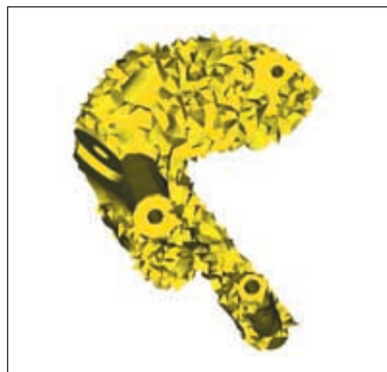
b. Topologieoptimierter Motorträger
