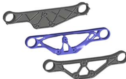
Optimierung eines Hinterachs-Querträgers (Mit freundlicher Genehmigung der Audi AG)
