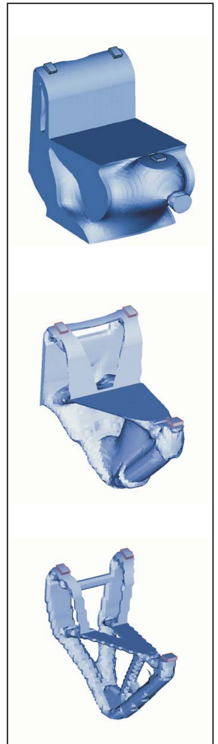
Abb.: Optimierungsablauf eines Bauteiles aus Kunststoff
