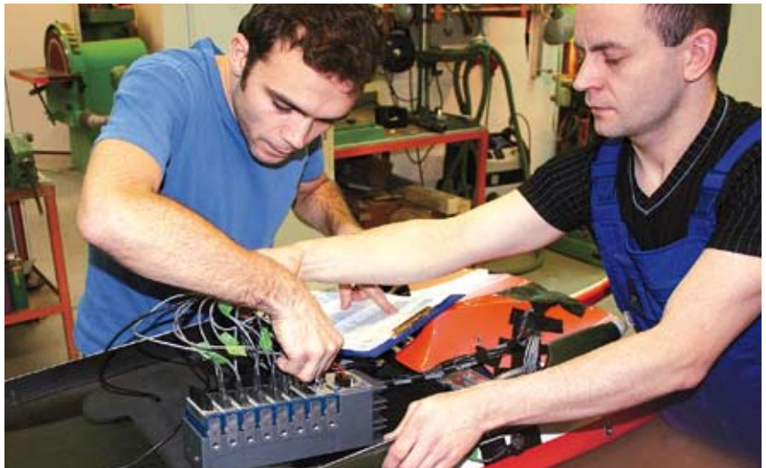
Testvorbereitung – Anbringung des Datenrecorders am Schlitten
