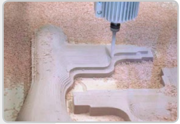
Herstellung eines Urmodells / Abformung für eine Negativform
