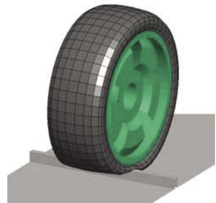
Modell: zwischen den rotierenden Rädern und der Straße einwirkende Reifenkräfte
